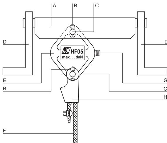
**Montage type pont roulant:**
