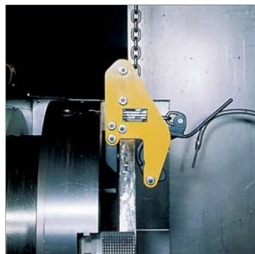
Pince universelle TWG avec des flasques modifiées pour espace confiné (exemple d'un tour).
