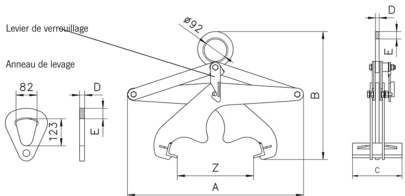
Modèle TR, anneau de levage pour charge de 2 000 kg et plus.
