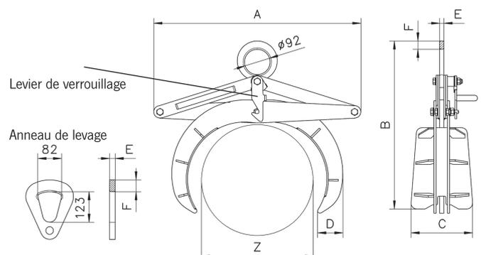
Modèle TRU, anneau de levage pour charge de 2 000 kg et plus. Levier de verrouillage en position ouverte.
